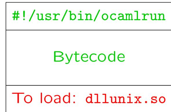
L'exécutable bytecode est indépendant de la machine cible.
